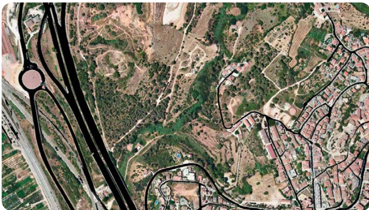
Resultados de la predicción unificando clases. En la imagen se pueden ver todas las clases de viales asfaltados que ha predicho el modelo, representadas indistintamente en color negro.
